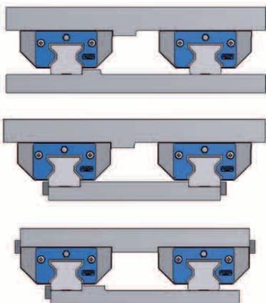
Qui accanto sono riportate alcune classiche tipologie di montaggio. Si differenziano per il tipo di fissaggio del pattino e della guida come pure per la posizione delle superfici di battuta della macchina.
