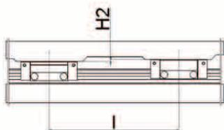
Per ottenere il valore massimo di scostamento ammissibile in senso longitudinale, sottrarre il valore di tolleranza della quota H (vedere tabella delle classi di precisione pag.10) al valore  $\Delta H2$  ricavato dalla formula sottostante:
