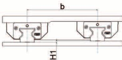
Per ottenere il valore massimo di scostamento ammissibile in altezza, sottrarre il valore di tolleranza della quota H (vedere tabella delle classi di precisione pag.10) al valore  $\Delta H1$  ricavato dalla formula sottostante:
