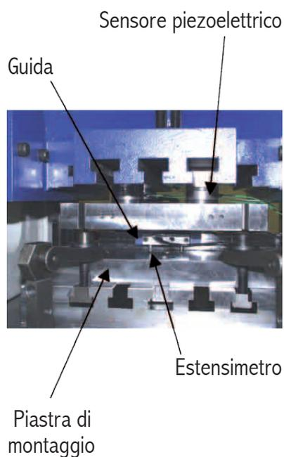
La misurazione della forza è effettuata tramite un sensore piezoelettrico disposto tra il cilindro idraulico e la piastra di montaggio su cui è fissato il pattino.
