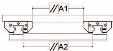
Le tolleranze indicate sono valide anche per guide e pattini montati senza spallamenti. L'errore di parallelismo A1 e A2 provoca un aumento del precarico, ma se non si superano i valori indicati in tabella, la sua influenza sulla durata nominale è generalmente trascurabile.
