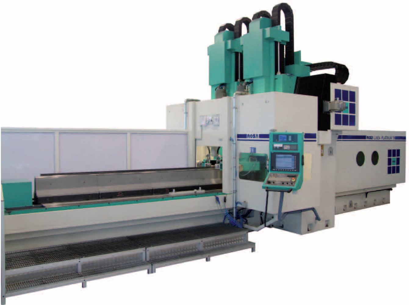
Doppelkopf-Schleifmaschine Platinum TH, Rosa Ermando SpA Im Einsatz bei der Herstellung der Führungsschienen MG
